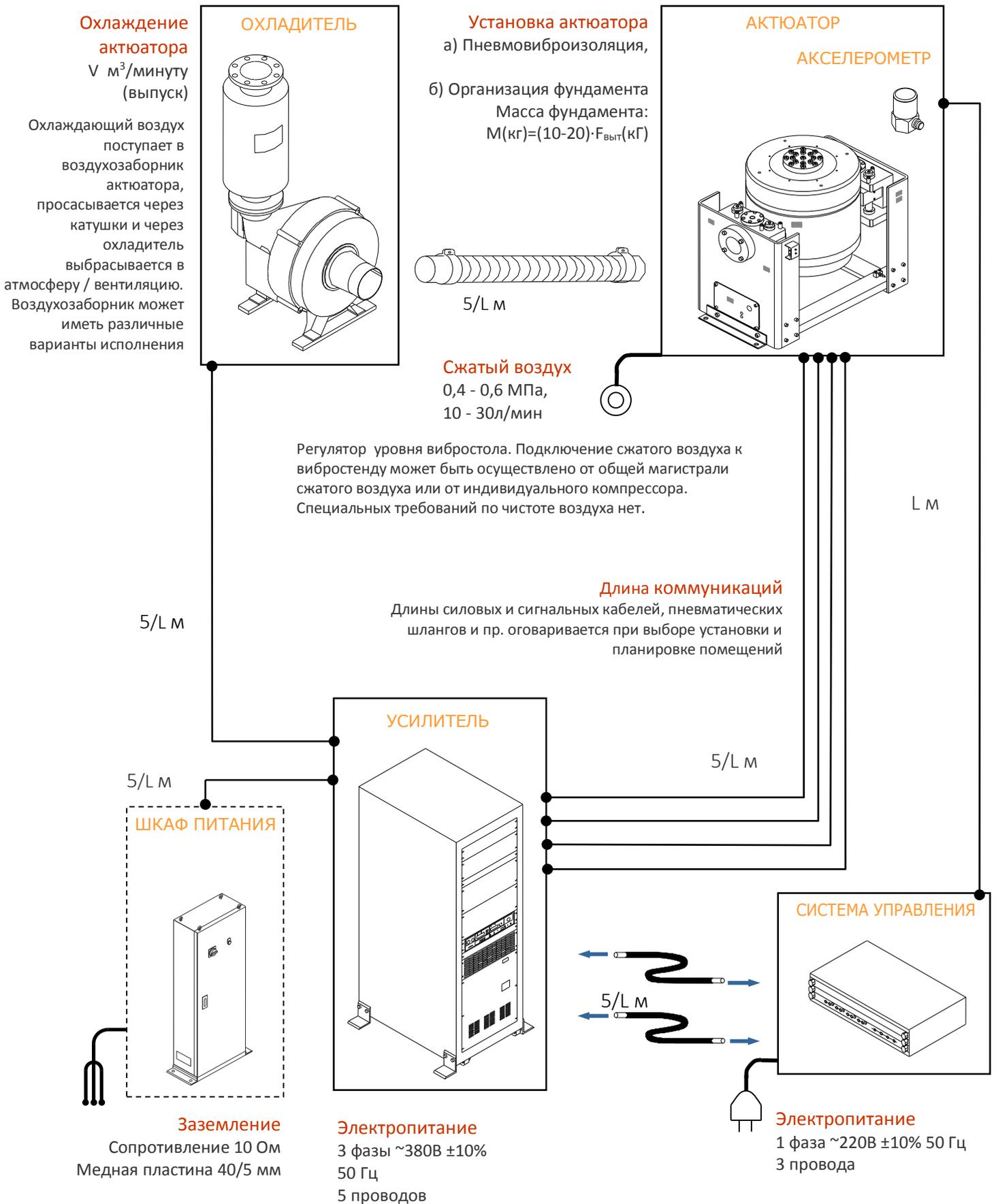
Схема подключения электродинамического вибростенда с воздушным охлаждением и/или с горизонтальным столом имеет существенные отличия.
